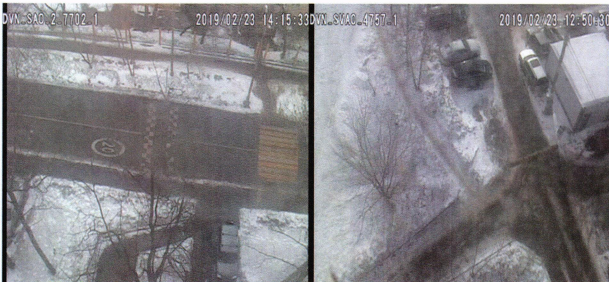
Рисунок 4. Незначительное загрязнение объектива камеры видеонаблюдения
