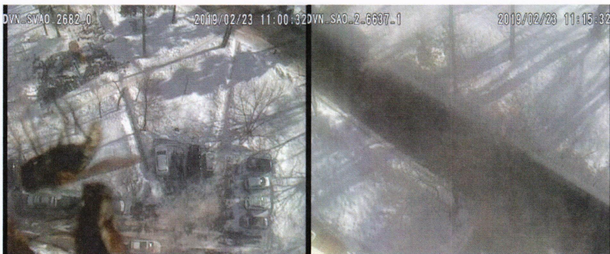
Рисунок 3. Значительное загрязнение объектива камеры видеонаблюдения
