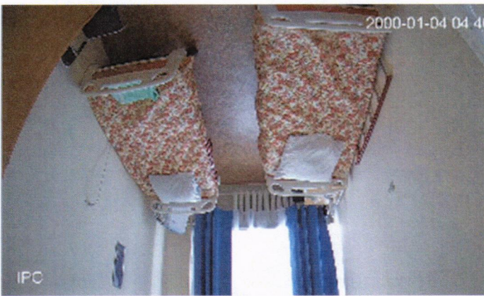
Рисунок 12. Некорректное положение корпуса камеры видеонаблюдения
